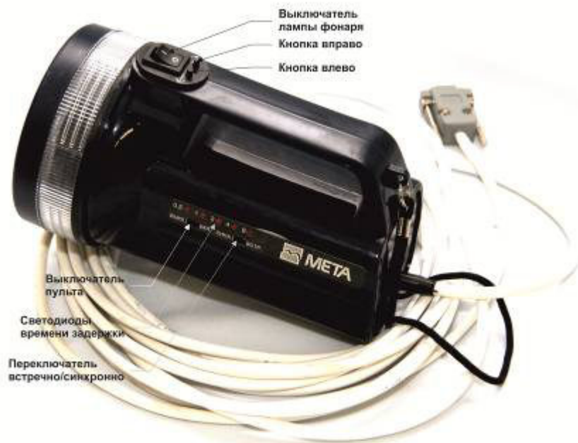
Рисунок 2 – Внешний вид пульта управления совмещенного с фонарем
